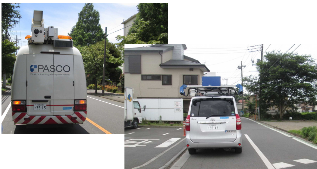
写真 路面性状調査
