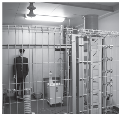
最高30万ボルトの高電圧を発生させる装置とその電圧を受ける川口太郎君（左）
