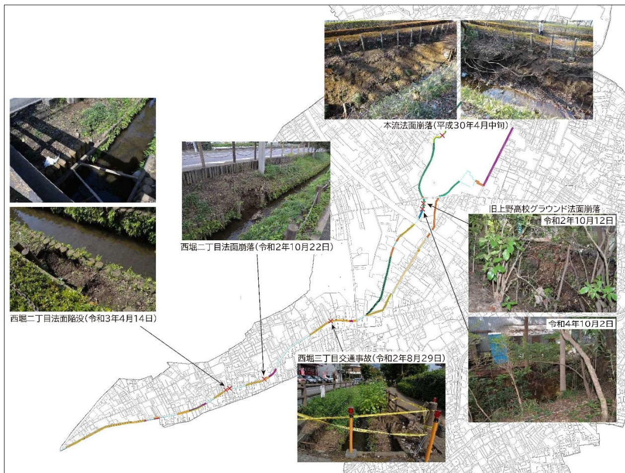
図 48：崩落危険箇所と近年のき損箇所
